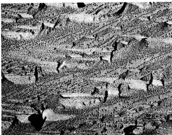
Abb. 2. Übersichtsaufnahme einer bei 423 °K auf ein NaCl-Spaltstück aufgedampften Goldschicht, Ta/W-beschattet, Kohleabdruck.
